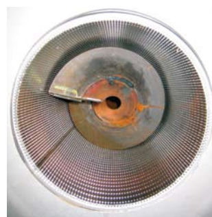
Invändig vy över pressrör i Wedge Weir och spiral i svart material S355J0.
