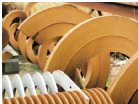
Spiraler i svart material innan utdragning.
