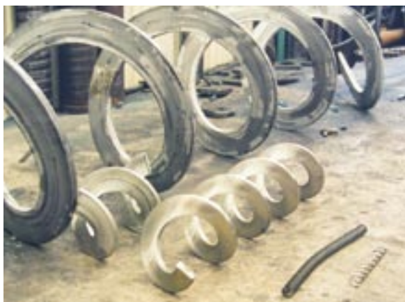
Rostfria spiraler med varierande diameter och stigning.
